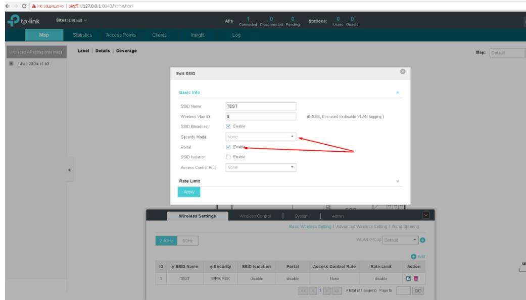
Рис. 6.3.2. Включение портала для выбранного SSID.
