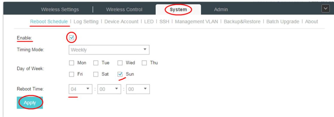
Рис. 9.1. Пример автоматической перезагрузки ТД в 04:00 по воскресеньям.
