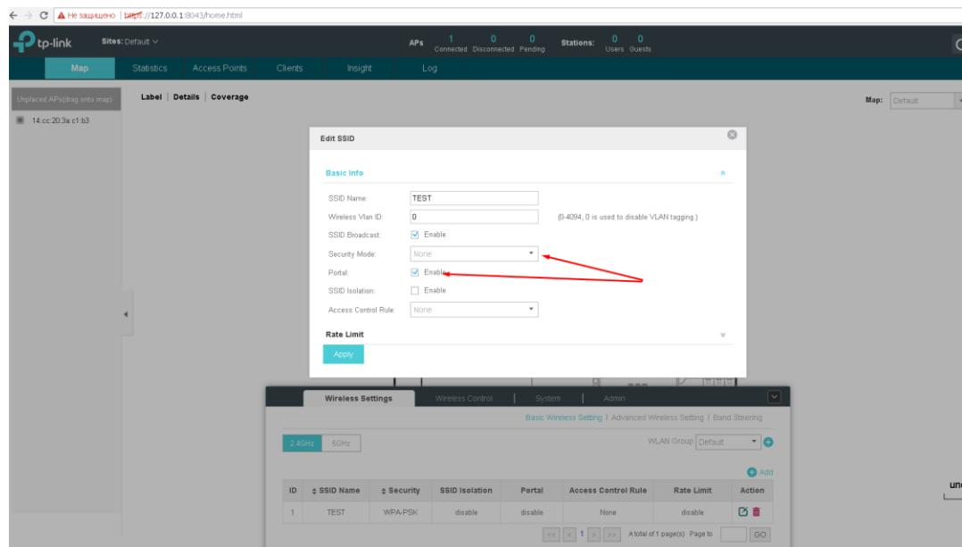
Рис. 6.1.2. Включение портала для выбранного SSID.
