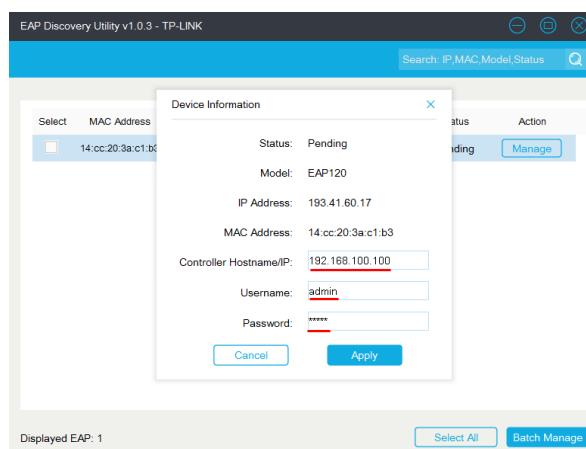
Рис. 4.3. Установка параметров подключения к контроллеру.
