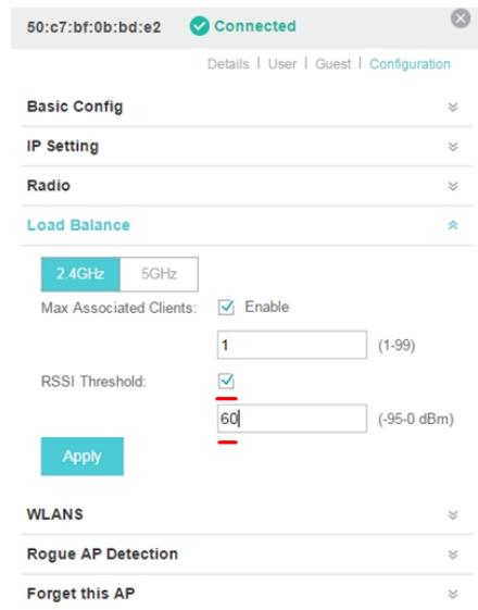
Рис 7.4 Установка мощности 60dBm при которой клиентское устройство будет отключено.
