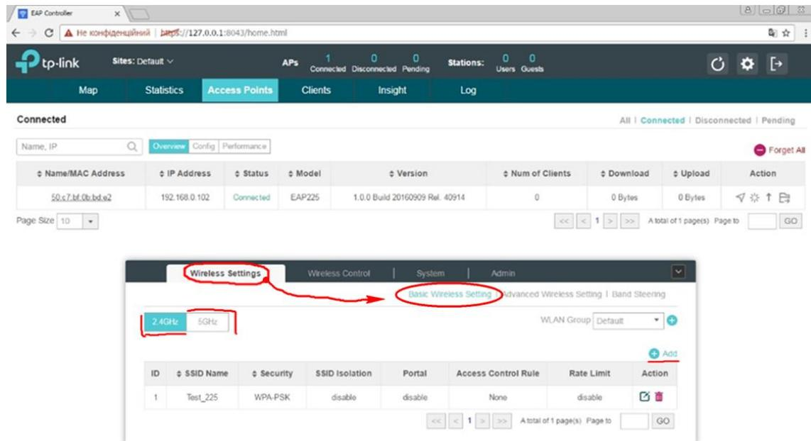
Рис.5.1. Меню "Wireless settings"-> "Basic Wireless Setting" кнопки выбора частоты вещания "2.4 GHz", "5 GHz " и кнопка "Add".
