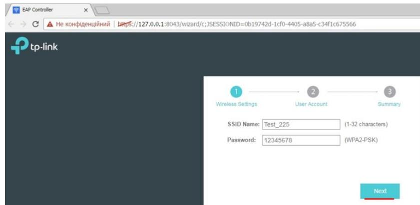
Рис. 2.2.4. Заполнение имени беспроводной сети (SSID) и пароля доступа к ней.
