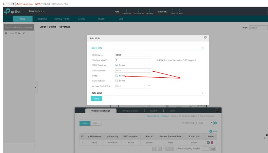
Рис. 6.2.2. Включение портала для выбранного SSID.
