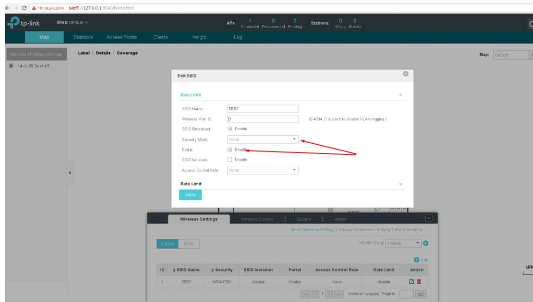
Рис. 6.4.2. Включение портала для выбранного SSID.
